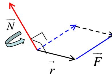
・粒子の(座標軸の原点Oのまわりの)回転の運動方程式
