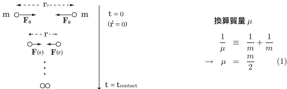
相対運動の(動径方向の)運動方程式より
