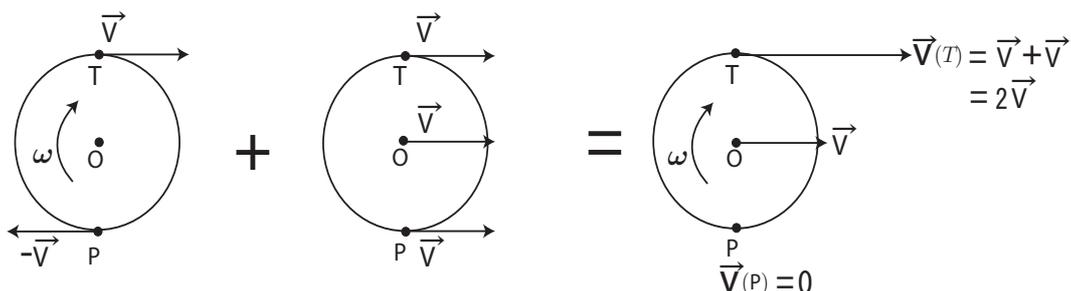
剛体が転がる面との接点の相対速度はゼロで、接点からもっとも遠い点の速度が大きいことを考えると、転がりは接点  $P$  を通る軸の周りの角速度  $\omega$  の微小な回転運動を連続的に合成したものである。この意味で、接点  $P$  を 回転の一時中心（または瞬間的な回転の中心）という。次に図では、転がる剛体の円周の各部分の速度ベクトルを示す。
