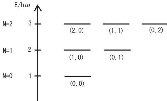
ているように、組み合わせ  $(n_x, n_y) = (N, 0), (N-1, 1), (N-2, 2), \dots, (0, N)$  という  $N+1$  重の縮退がある。
