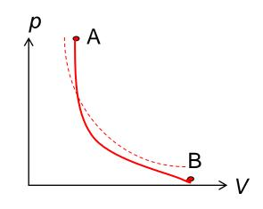
断熱圧縮 $(V_A > V_B)$ すると温度上昇 $(T_A < T_B)$  空気入れの際の発熱
